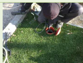
campionamento acque di falda
