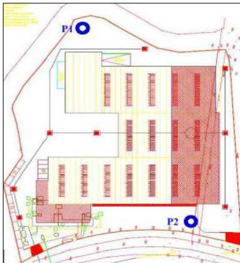
Ubicazione dei n. 2 piezometri
