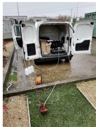
Piezometro PZ2, fasi di prelievo.
